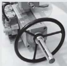
Встроенный в привод ручной дублёр
