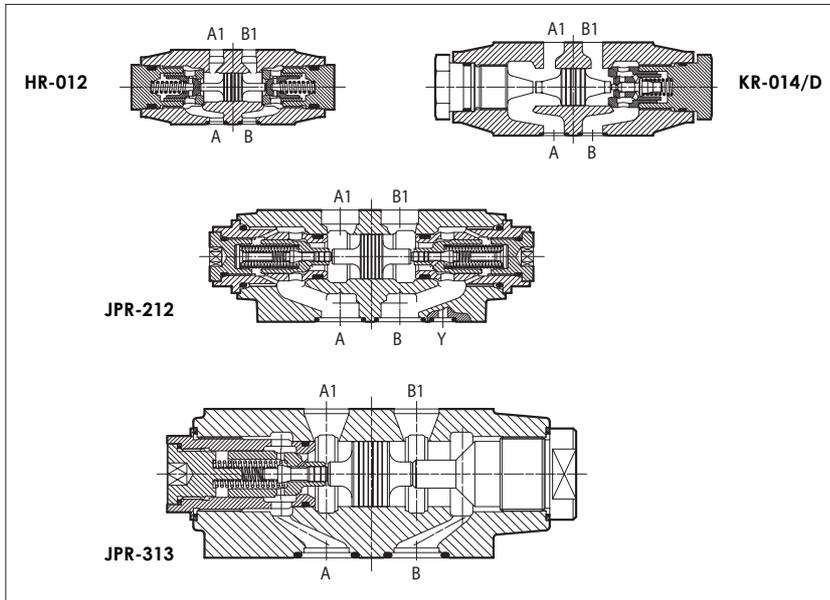
HR, KR - обратные клапаны, прямого действия или гидрозамки.
