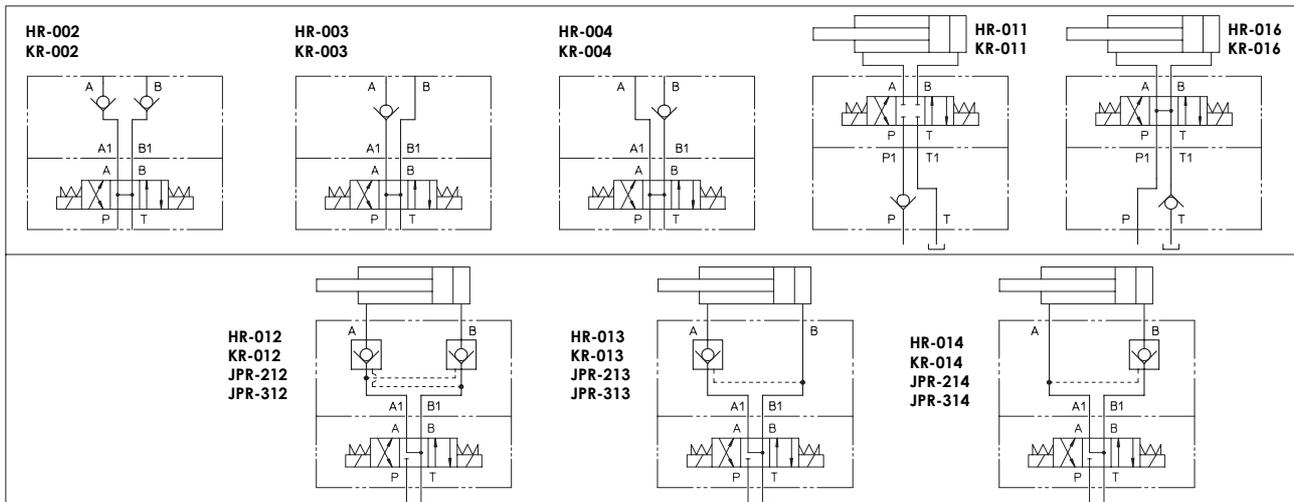
Давление управления, приложенное через каналы A или B, открывает клапан, действующий на каналы B или A соответственно.
