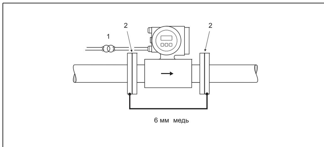
1 = изолирующий трансформатор, 2 = электрически изолированный
