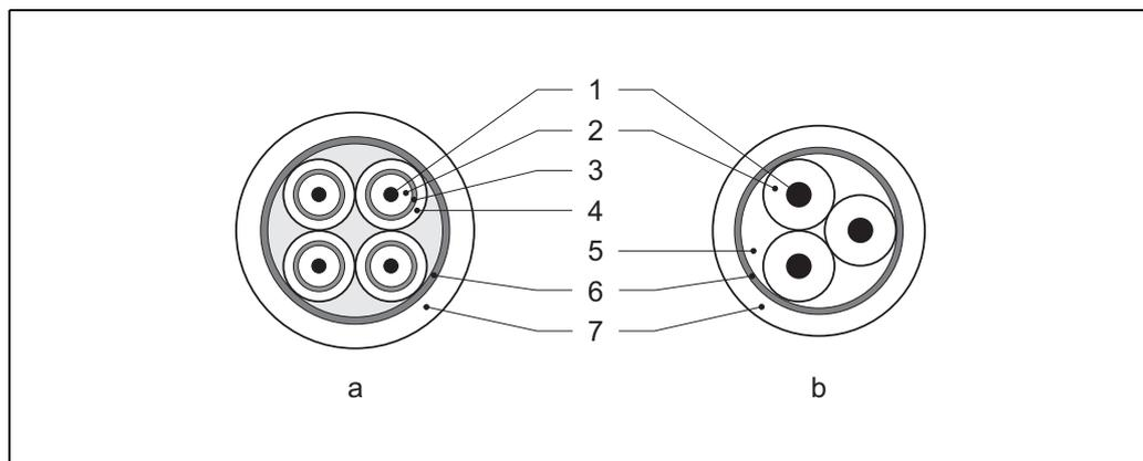
*a* = сигнальный кабель, *b* = кабель катушки (сечение: макс. 2.5 мм<sup>2</sup>)
