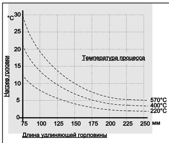
На основании рис. 4 можно сделать вывод о том, что длина удлиняющей горловины может влиять на температуру на головке. Эта температура не должна выходить за пределы значений, указанных в разделе "Рабочие условия". Перед выбором соединения рекомендуется ознакомиться с этим графиком и выбрать подходящий удлинитель для предотвращения нагрева головки.
